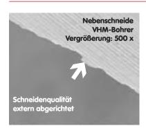
Schleifwerkzeug.D64 Q-Flute⁺ DressAbrichtwerkzeug:WINTER DDS AbrichtrolleSchleifmaschine:Walter Helitronic, KSS: ÖlWerkstück:Hartmetall Fräser, Ø16 mm
