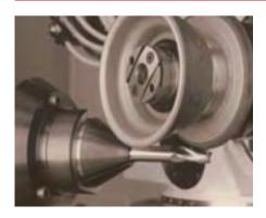
B64 Q-Flute<sup>2</sup> Schleifwerkzeug: Schleifmaschine: ITM, KSS: Öl Werkstück: HSS Senker, Ø15 mm
